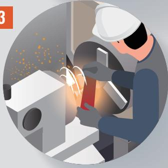
**무엇이 위험한가요?** 안전장치 미설치 또는 설치된 안전장치 무력화
